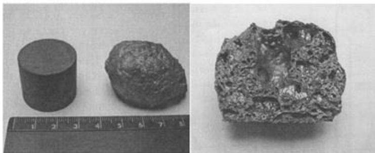
Рис.9. Зовнішній вигляд брикетів з модельних сплавів до спікання (ліворуч) та після спікання при 1200^{\circ}\text{C} (праворуч)
